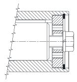
6 Contour Bolt (DIN ISO 4014 . DIN ISO 4017) (DIN ISO 8765)
